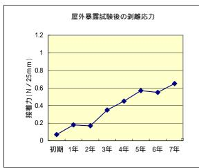
積水化学ビニクロステープ使用。 ビニクロステープの焼き付けアクリル面への 常態接着力は18N・25mmである。
